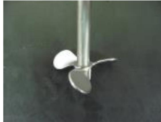
※ 推奨する攪拌羽根を使うことで、**油の滴下スピードを速く出来ます。**
