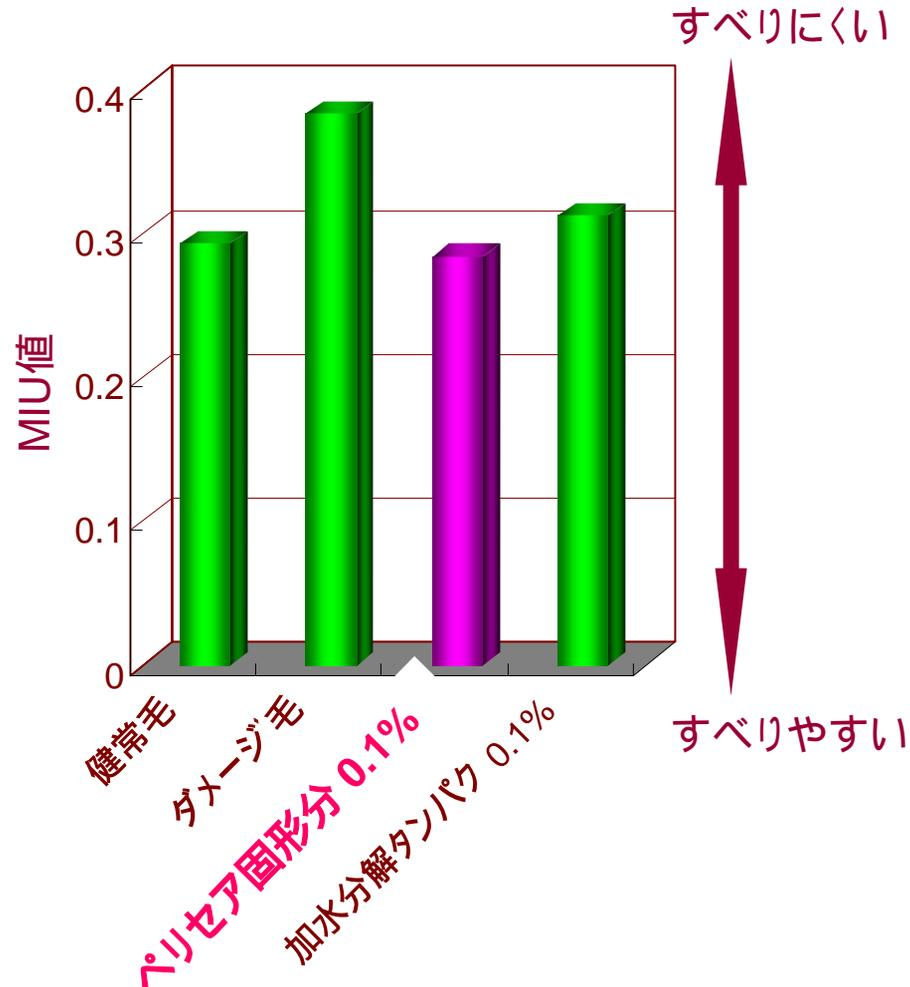
試験条件: 31~32、44~46%RH、毛髪20本、機種カトーテック KES-SE、速度1.0mm/s、荷重25g、センサー種類シリコン
